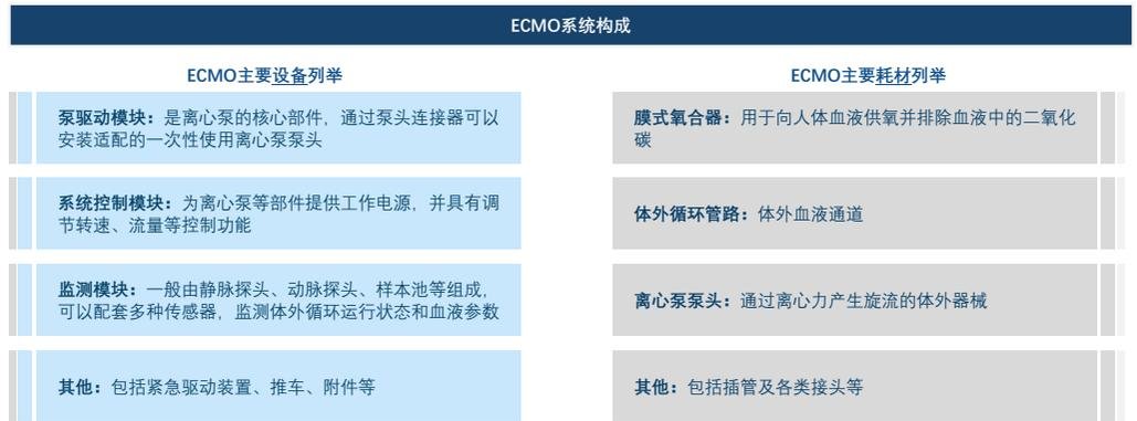
ECMO系统所有组件中，离心泵及膜式氧合器为主要核心组件，分别起到人工心脏和人工肺的作用。离心泵（人工心脏）为血液的动力驱动装置，保证其在管道中持续流动。膜式氧合器（人工肺）可模拟肺脏功能，促进氧气及二氧化碳的交换。
